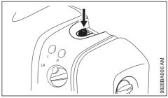
► 手動燃料ポンプを最低 5 回押してください - ポンプに燃料が充塡されている場合でも、同様の操作を行います。
