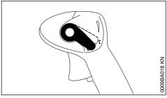
▶ 調整レバーを 0 の方向に動かします - エンジンが停止して、調整レバーが「オン」位置に戻ります。
