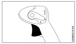
▶ スロットル トリガーを操作します。
