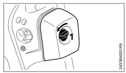
► フィルター カバー ロック (1) を、垂直位置まで反時計回りに回します。
